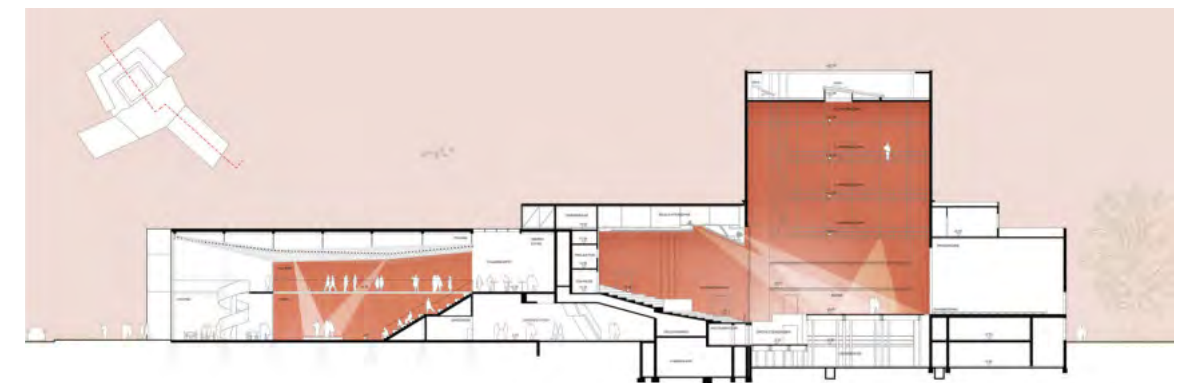
Längsschnitt durch Neubau und Bestand
